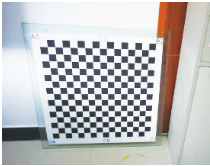
图5 用钢化玻璃板粘贴打印靶标制作的标定板实物
