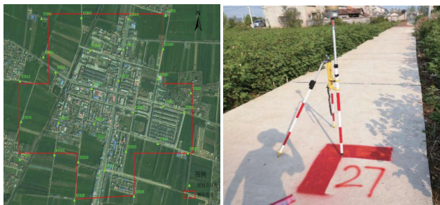
图2 控制点布设和测量
