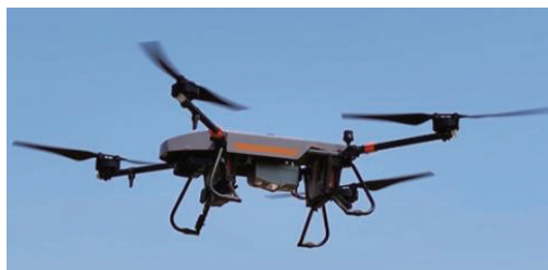
图3 华测BB4四旋翼航拍无人机移动测量系统
