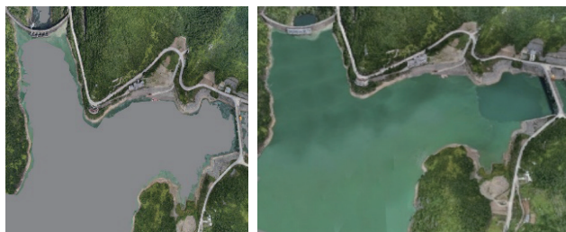
图2 水面空洞精细化修复后效果
