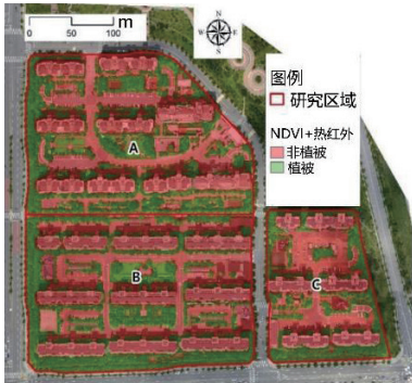
图5 基于NDVI和热红外结合的植被分类结果
