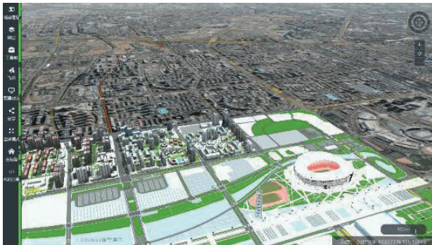
图1 无人机倾斜摄影获取的影像数据
