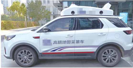
图2 车载移动测量系统
