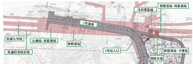
图4 道路施工影响范围内地铁轨道
