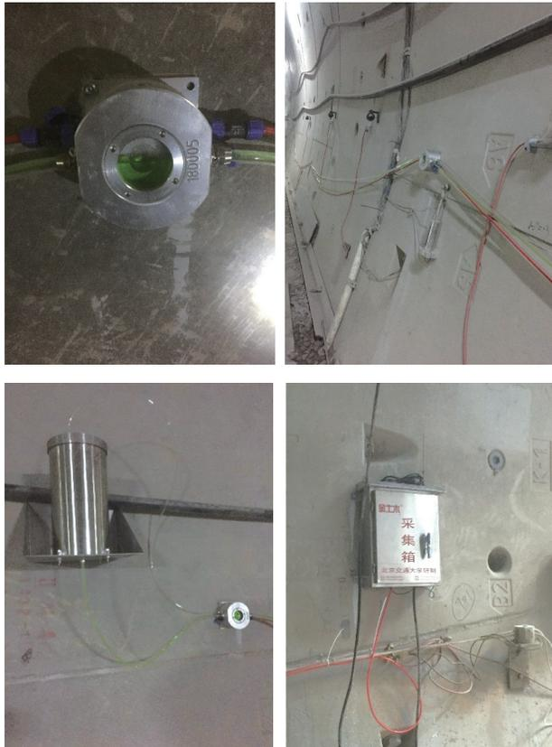
图6 静力水准测量监测点
