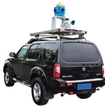
图1 车载移动测量系统
