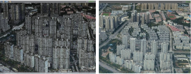
(a) TIN白膜(部分) (b) 实景三维模型(部分)
