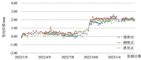
图6 竖向位移最大位置（里程484m）时序变形曲线
