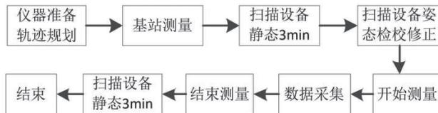
图2 背包式SLAM三维激光扫描系统外业流程
