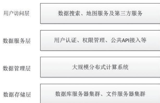
图1 云存储平台架构设计
