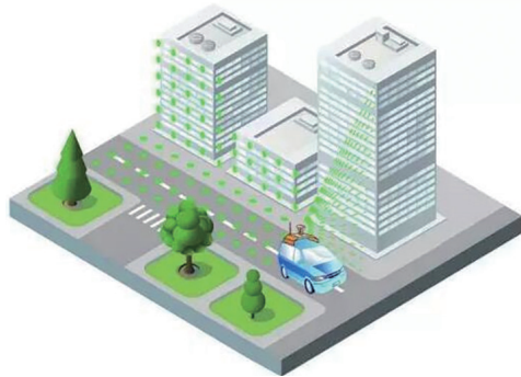
图1 车载LiDAR移动测量系统作业示意图
