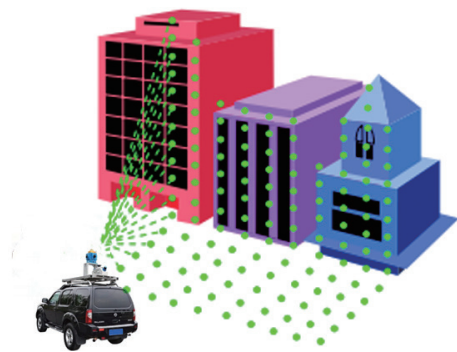
图1 车载LiDAR移动测量系统工作原理
