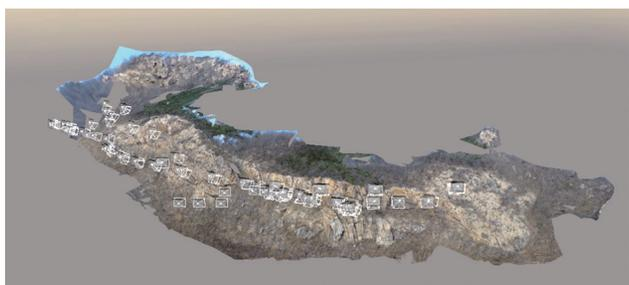
图4 测区无人机航拍图片分布与实景三维模型
