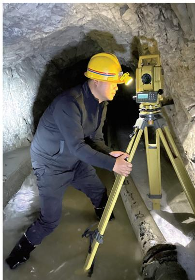
里冒着气泡，一股怪味迎面扑来。三人没有犹豫，立即扛着仪器，蹭着泥水进入洞中。洞内漆黑一片，洞高不足1.6米，魏亚南猫着腰架好仪器，其他两人提着矿灯在洞内寻找高程和地形变化点。数据采集完成后，三人顾不上休息，便赶回单位，加班加点计算洞内高程数据，绘制出洞内走向图形，第一时间交付到栾县长青钨钼有限责任公司的工作人员手中。
