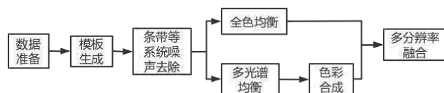
图2 卫星影像匀光匀色处理流程
