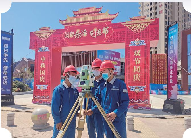
● 水平控制基准网导线测量（郑州中核岩土工程有限公司 任伯坤 / 摄）
