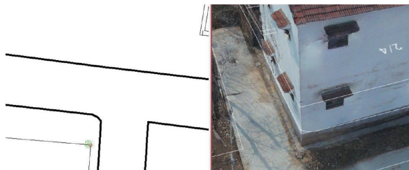
图6 检核点点位精度 (红圈为矢量点, 绿圈为检核点)
