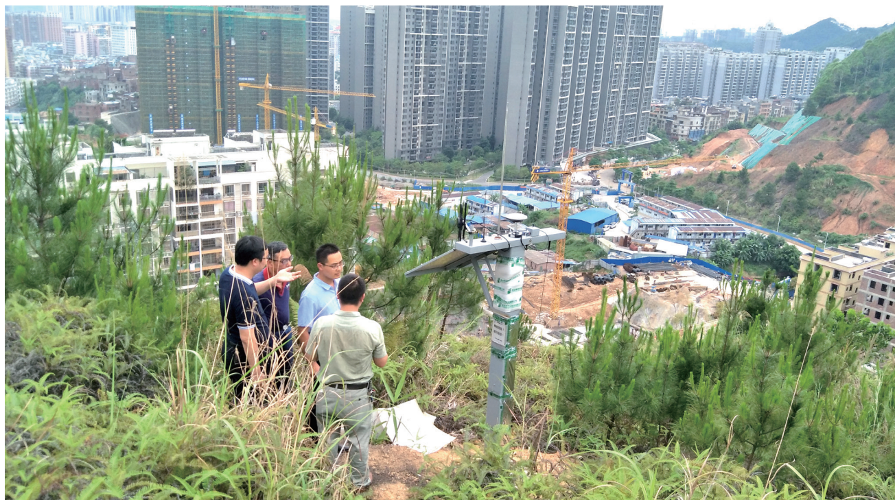
● “北斗+广播”边坡高精度自动监测系统在梧州市长洲区宝石园滑坡地灾隐患点开展试运行 黄尚宁/摄
