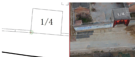
图7 检核点点位精度 (红圈为矢量点, 绿圈为检核点)
