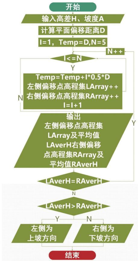
图2 自动寻坡算法流程图
