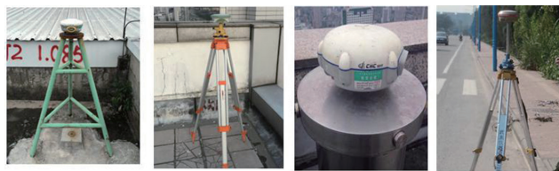
图12 仪器兼容性检测(分别为天宝、徕卡、华测、南方)
