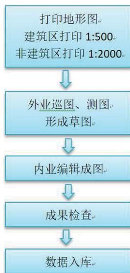
图1 修测更新基本流程
