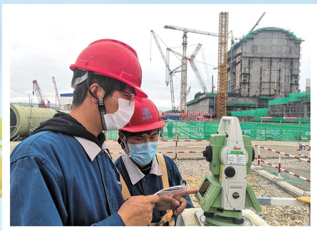
● 水平位移基准网测量（郑州中核岩土工程有限公司 朱双伟）
