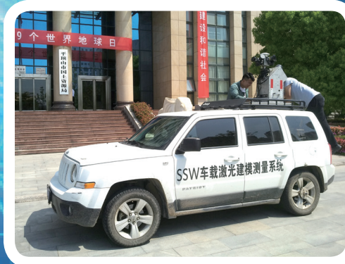
● 引入车载移动激光测量设备
