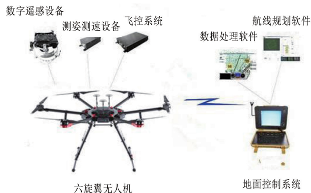
图1 无人机航测系统组成
