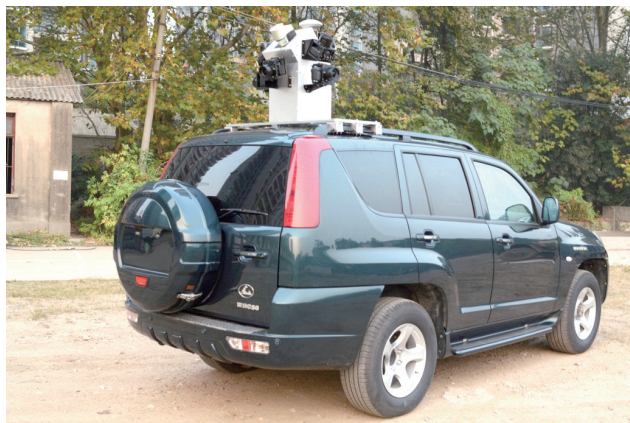
图1 车载LiDAR测量系统
