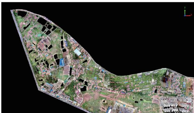
图9 纹理映射后的点云数据
