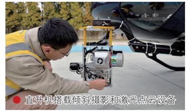
● 直升机搭载倾斜摄影和激光点云设备
