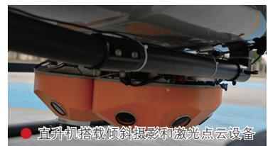
● 直升机搭载倾斜摄影和激光点云设备
