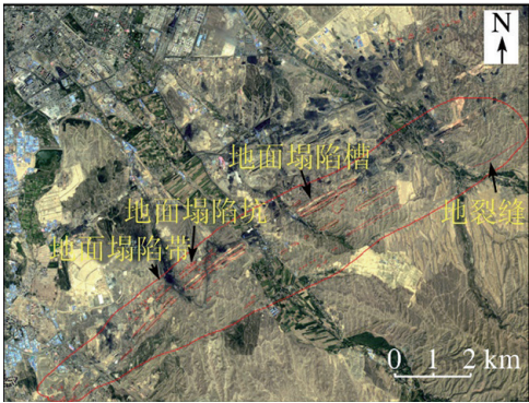
图3 地面坍塌地裂缝遥感影像
