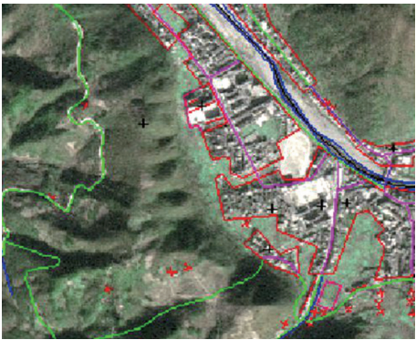
图2 卫星正射影像与数字栅格地图叠加更新后地形图
