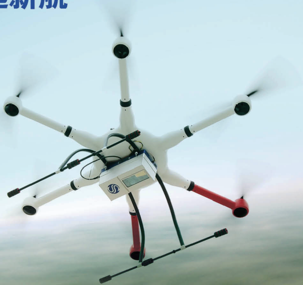
GOL260 机载激光雷达 非接触式主动测量系统
