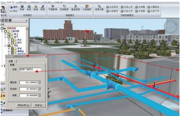
图5 地下三维管网效果图
