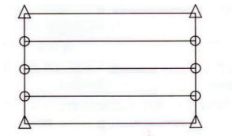
图2 像控点布网方案示意图
